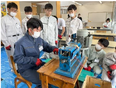
機械による銅線への切り込み作業
