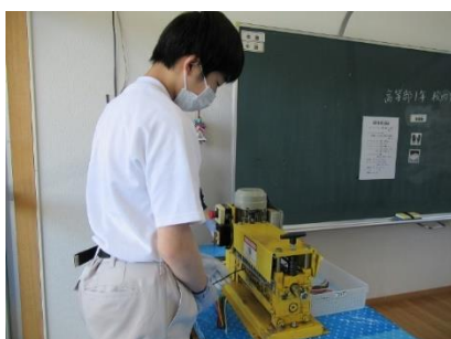
機械による銅線のビニールへ 切れ目を入れる作業
