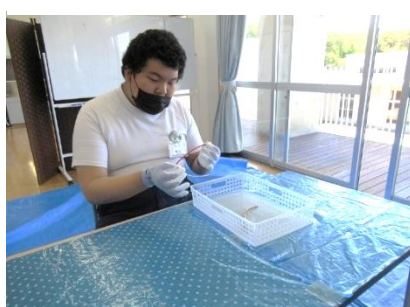
ビニールから銅線を 取り外す作業
